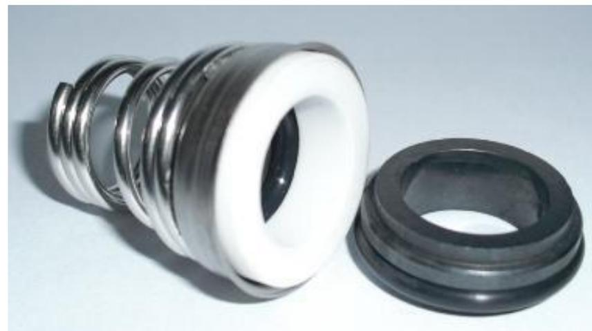
Esta família de selo mecânico fabricado em diversas versões utiliza a mola wave ou multimolas para transmissão do torque, ou seja, para sua instalação deverá ser informado o sentido da rotação do eixo. Muito utilizado em indústria têxtil e alimentícia,
